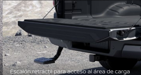
Escalón retráctil para acceso al área de carga
